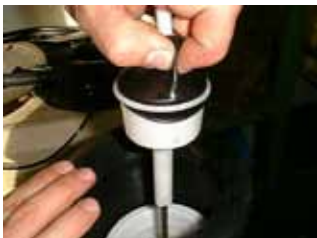
17. Ułożyć membranę centralnie przez przewinięcie w tył do uformowanego zawinięcia i wcisnąć w zawór.
