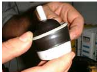
16. Nasunąć podgrzany pierścień (3 minuty w wodzie o temperaturze około 50°C).
